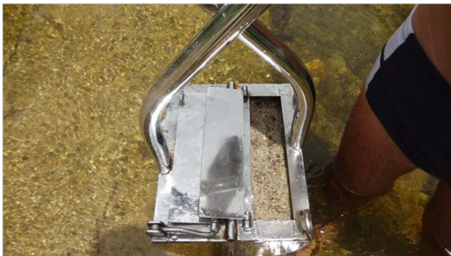
Figura 5.1.69. Visão Draga tipo Van Veen adaptada durante a coleta.
